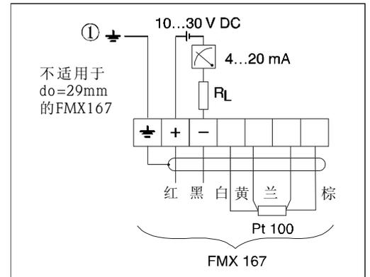
带Pt100温度传感器和TMT181温度变送器的Waterpilot FMX167(4...20 mA)
