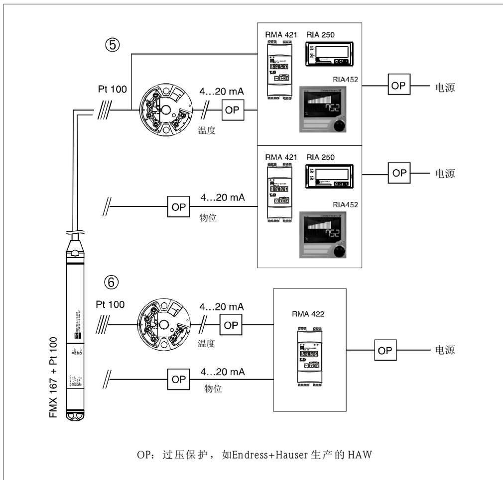
带Pt100温度传感器的FMX167的应用实例
